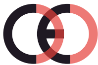
Virheellinen CE-merkki (liian lähellä)
