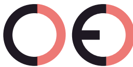
Virheellinen CE-merkki (liian kaukana)
